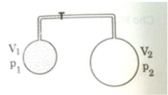
Hình. Một bình chứa khí thông với một bình hút chân không
